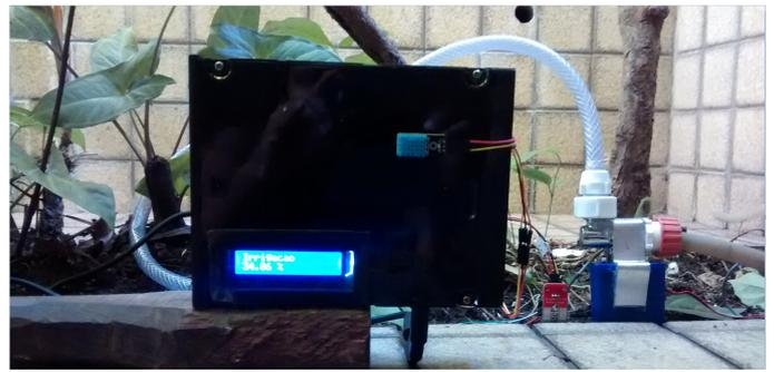
Figure 12: Protótipo do Controlador Fuzzy Arduino.
