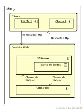
Figura 4. Diagrama de Implantação do S.A.R.A..
