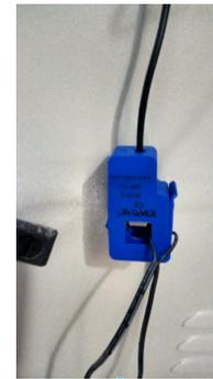
Figure 25: Posicionamento do sensor SCT-013 20A.
