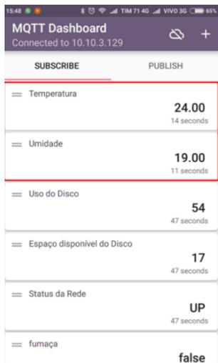
Figure 35: Inclusão das medições de temperatura e umidade.
