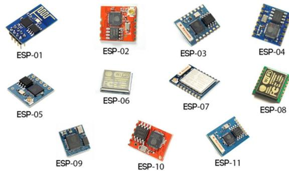
Figure 8: Versões do módulo ESP8266[14].
